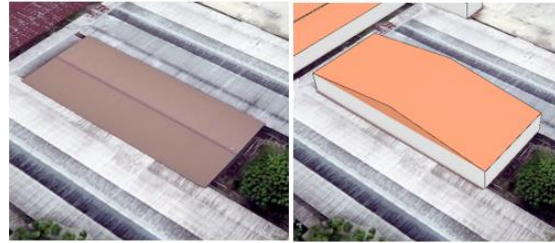
Gambar 22. Kesalahan orientasi atap bangunan
