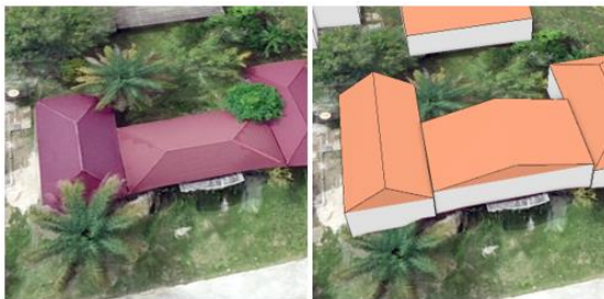
Gambar 21. Kesalahan jenis atap bangunan
