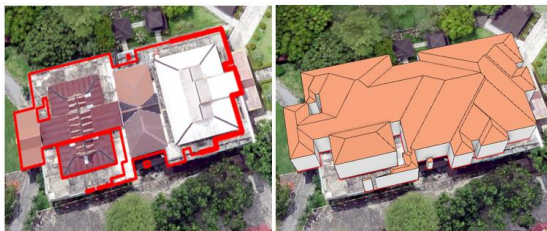
Gambar 20. Kesalahan karena footprint bangunan yang tidak tepat
