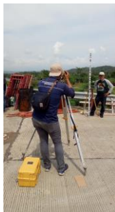
Gambar 7. Pengukuran levelling di titik WP_1
