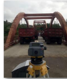
Gambar 8. Pengukuran levelling di empat titik pengamatan
