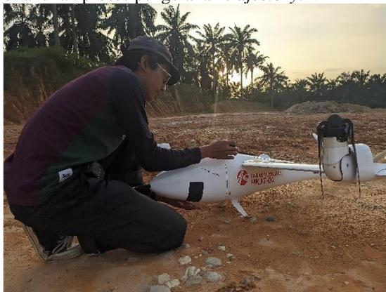
**Gambar 5.** Perangkaian UAV LiDAR
