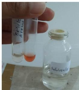
Gbr. 8 Uji larutan ion Fe sebelum adsorpsi dan setelah adsorpsi menggunakan pengompleks KSCN.
