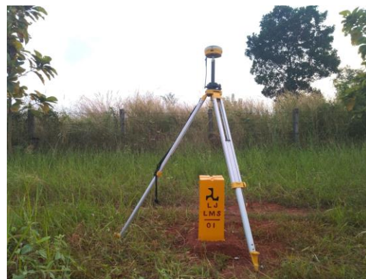
Gambar 1. Pengukuran Patok Titik Referensi menggunakan metode GNSS secara statik
