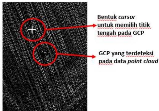
**Gambar 15.** Ilustrasi uji akurasi horizontal
